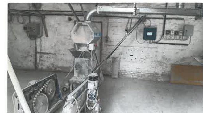
Figur 4. 2-strengs anlæg og portionsvægt. Foderet kommer ind via sneglerenden fra færdigvaresiloen placeret udenfor. Derfra afmåles en portion foder i vægten, og dette tildes enten rød foderkæde (hold på start foder) eller blå foderkæde (hold på slutfoder) afhængig af, hvilken trækstation der er sat til at køre. Der kan kun køre én trækstation ad gangen.
